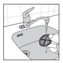
3 Deje que el filtro se seque por completo al aire. Vuelva a colocarlo en la base y cierre la cubierta del filtro.
